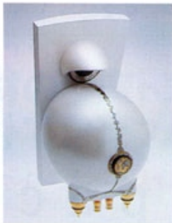
エンクロージャーは、定在波をキャンセルし不要な付帯音を消生させない独特な形。
